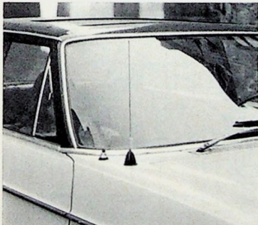
Bild 8. Die montierte 40 cm lange aktive Autoantenne
